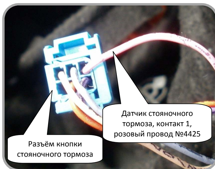
Рис. 8: Подключение датчика стояночного тормоза.
