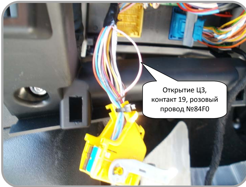
Рис. 3: Подключение цепи открытия ЦЗ.
