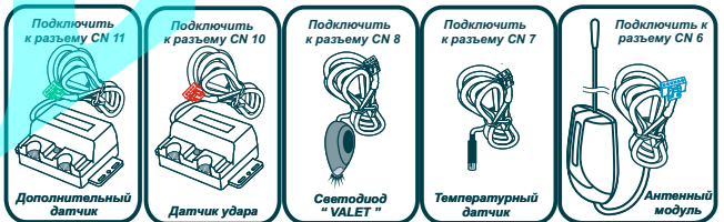
Схема подключения Scher-Khan Logicar 4 к автомобилю CITROEN DS5 с кнопкой Старт/Стоп и функцией «свободные руки»
