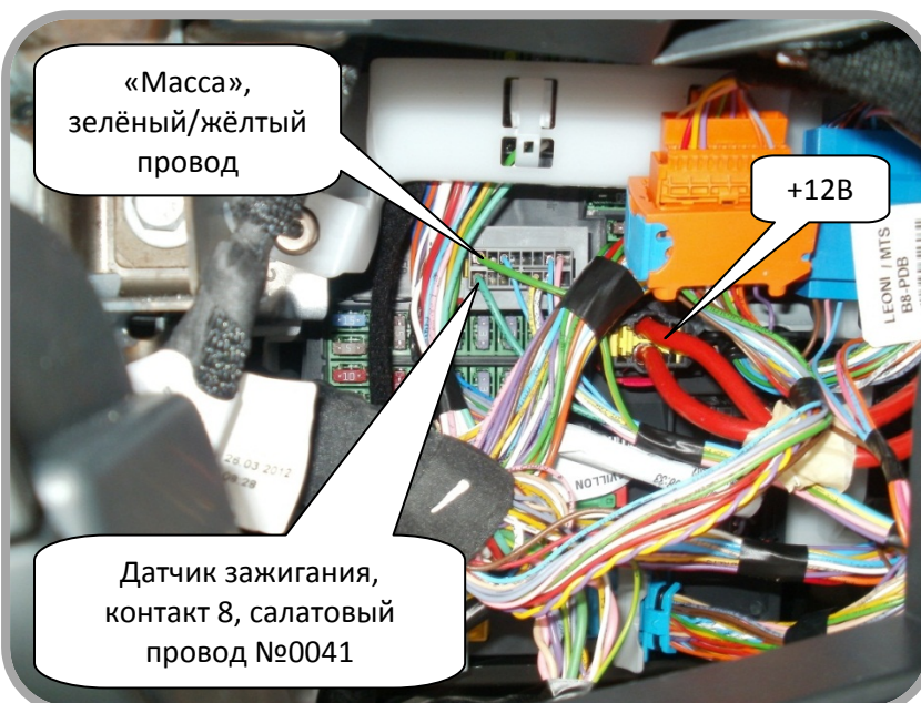
Рис. 4: Подключение датчика зажигания и питания системы.
