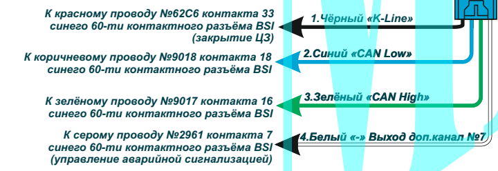
Схема подключения Scher-Khan Logicar 4 к автомобилю CITROEN DS5 с кнопкой Старт/Стоп и функцией «свободные руки»
